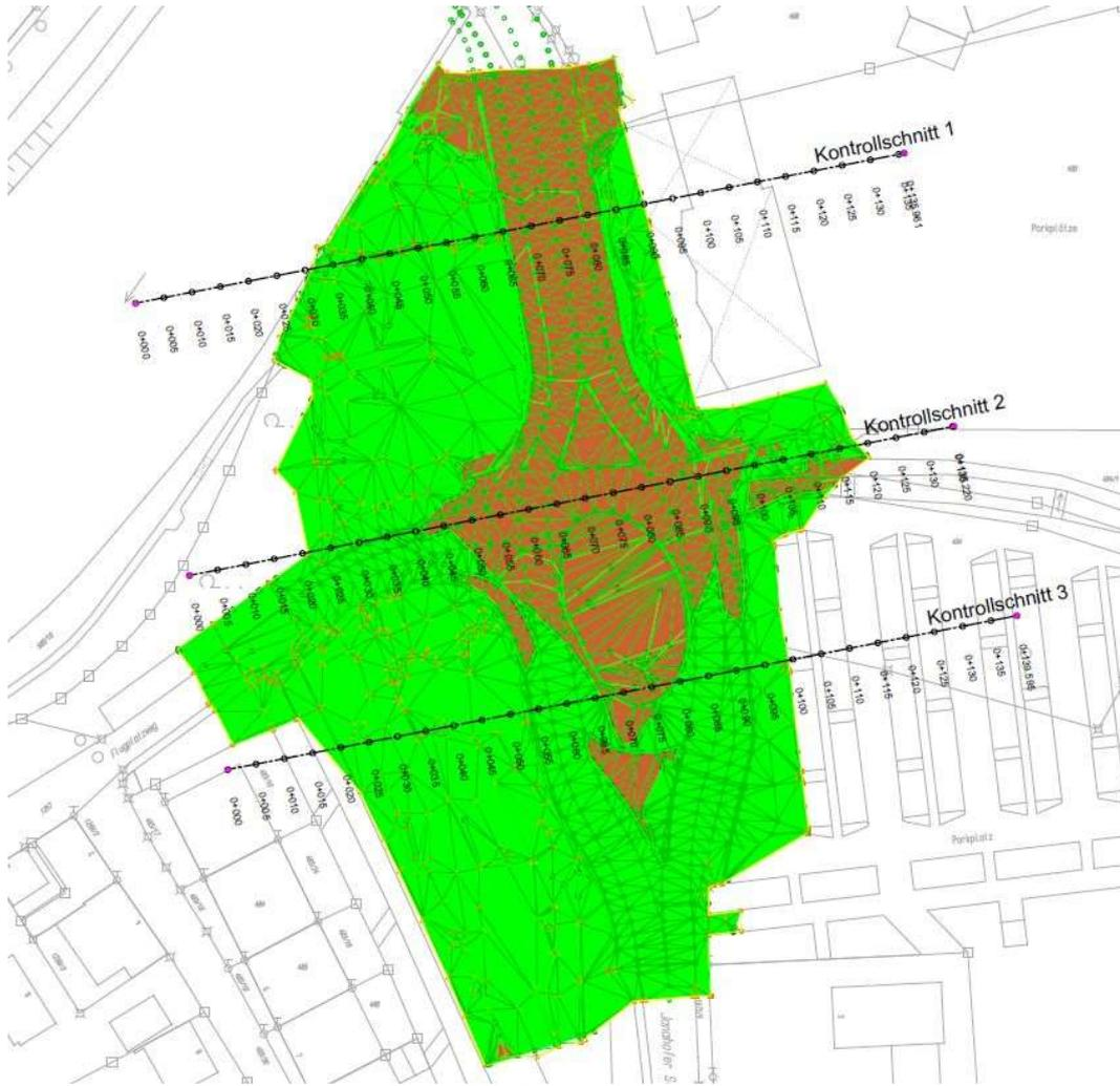
Bild 3.4: Massenvergleich Planung - HQ 100, Auftrag = ÜSG „grün“, Abtrag „Braun“
